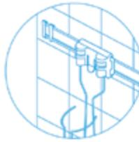
Die hygienische Schiene wird auch für Toolflex One Zubehör verwendet, z.B. mit Haltern für Flaschen, Handschuhboxen und Maskenboxen.
